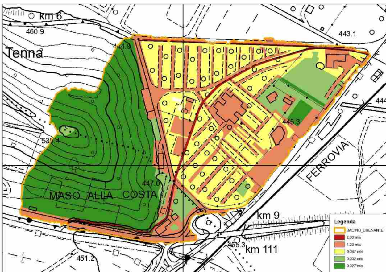
Fig. 3.3 – Raster distribuito dei valori di velocità di propagazione del deflusso utilizzati sul bacino in esame.
