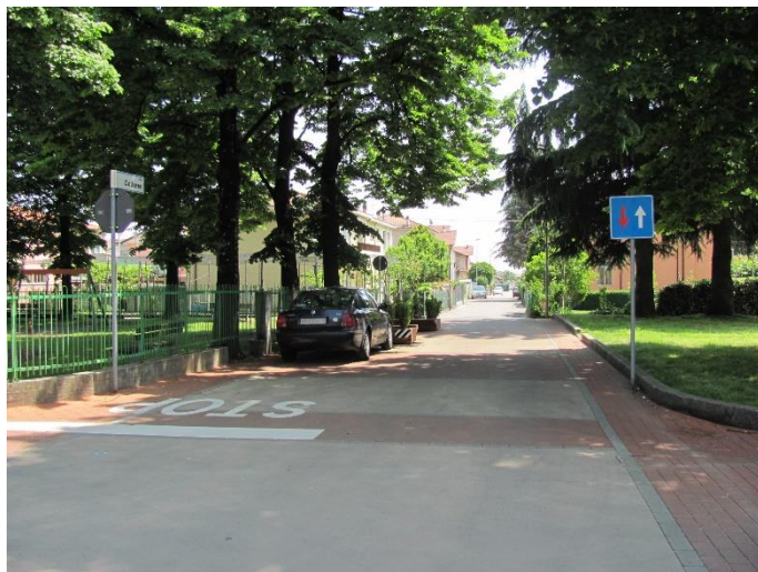
Secondo modello: strada a senso unico, con sosta organizzata in linea e percorsi pedonali a raso o rialzati
